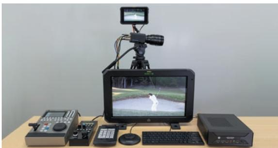
録画中は、ライブ表示、遅延表示が可能です。様々な表示設定が出来ます。録画時間、録画中の遅延表示時間録画停止時の動作、エンコード後ファイルの転送先、静止画の設定、メモリ分割使用設定、ライブ表示、スロー再生時にそれぞれ静止画重ね合わせや線を引くなどオーバーレイ表示に対応しています。
