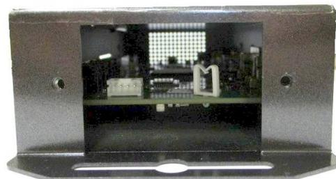
※万が一クランプが破損した場合は、ファンモジュール取付時に、ケーブルを奥に入るように調整をお願いします。
