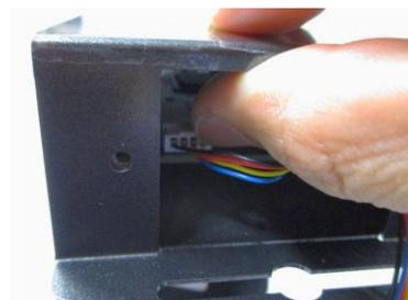
2-6. ファン側のケーブルを、クランプの中に押し込むようにして、ケーブルがおおよそ4cmくらい外に出た状態にします。
