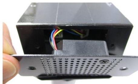
2-8. 2か所をねじ止めします。片側ずつ仮止めし、最後に本締めします。（きつく締め付ける必要はありません）。
