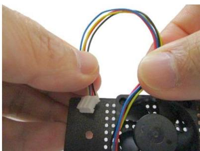
2-3. 掴んだケーブルの中央をクランプの上へのせ、指差で下に押さえるとケーブルがクランプに挟まります。
