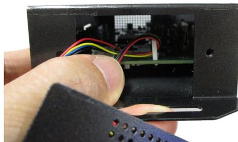
1-6. 指で下に押して、ケーブルをクランプの間に押し付けて、クランプから外します。
