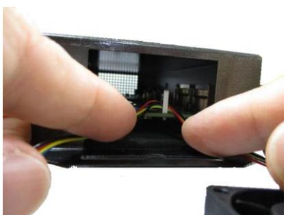
2-4. コネクタを接続します。黒いリード線が左側になるように持ち、内部のコネクタに、まずは軽く接続しておきます。
