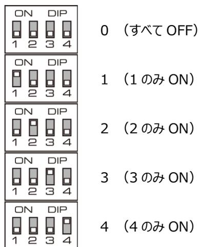
また、DIPSW の ON/OFF の組み合わせで 16 通りのリモコン信号を識別できます。
