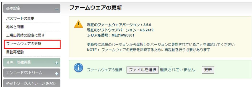
ファームウェアの選択 : [参照]ボタンでブラウザを開いている P C 上のファイルを選択し[更新]ボタンを押すとアップデートが開始されます。
