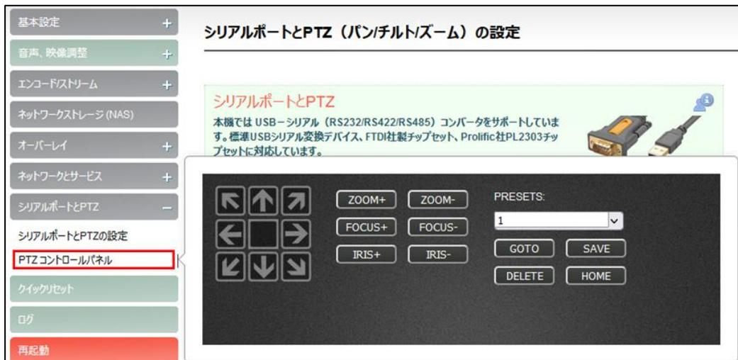
コントロールパネルを操作して、カメラの動き、ズーム、フォーカスを全方向にコントロールすることができます。
