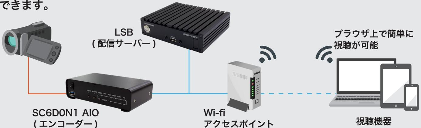
※エンコーダー・・・カメラ等からの映像と音声データをネットワークで伝送できるよう圧縮・変換できる機器です。
