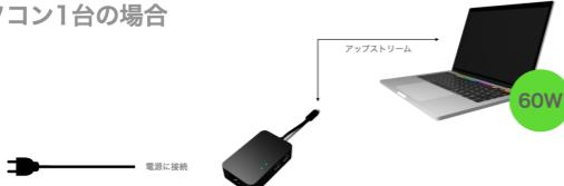
本機に AC 電源を接続してパソコンと接続した場合、バスパワーモードと同じように動作しますが、給電は本機から行われるようになります。パソコン本体に給電される電力は、接続している機器によって変化します。
