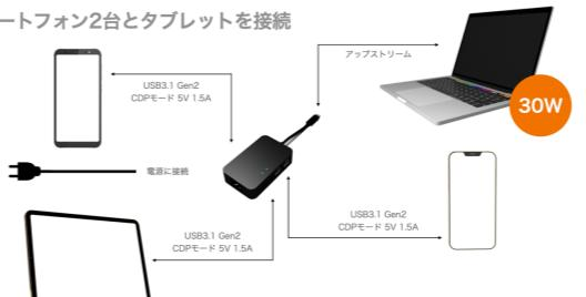
接続している機器の数によって、自動的にパソコンに供給される電力が変化します。バスパワーで動作している状態で AC 電源ケーブルを本機に接続した場合、それぞれの接続が一度リセットされます。
